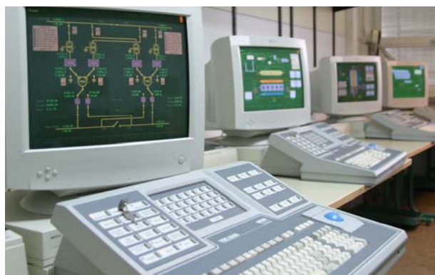
»Full Scope« Transas ERS 4000 konzola ladijske strojnice in »Workstation« Kongsberg-Norcontrol ver. 2005 izvedba ladijske strojnice
