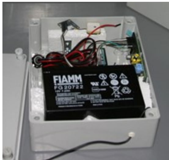
Slika 20: Detektor v vodo-neprepustnem ohišju in pogled v notranjost detektorja
