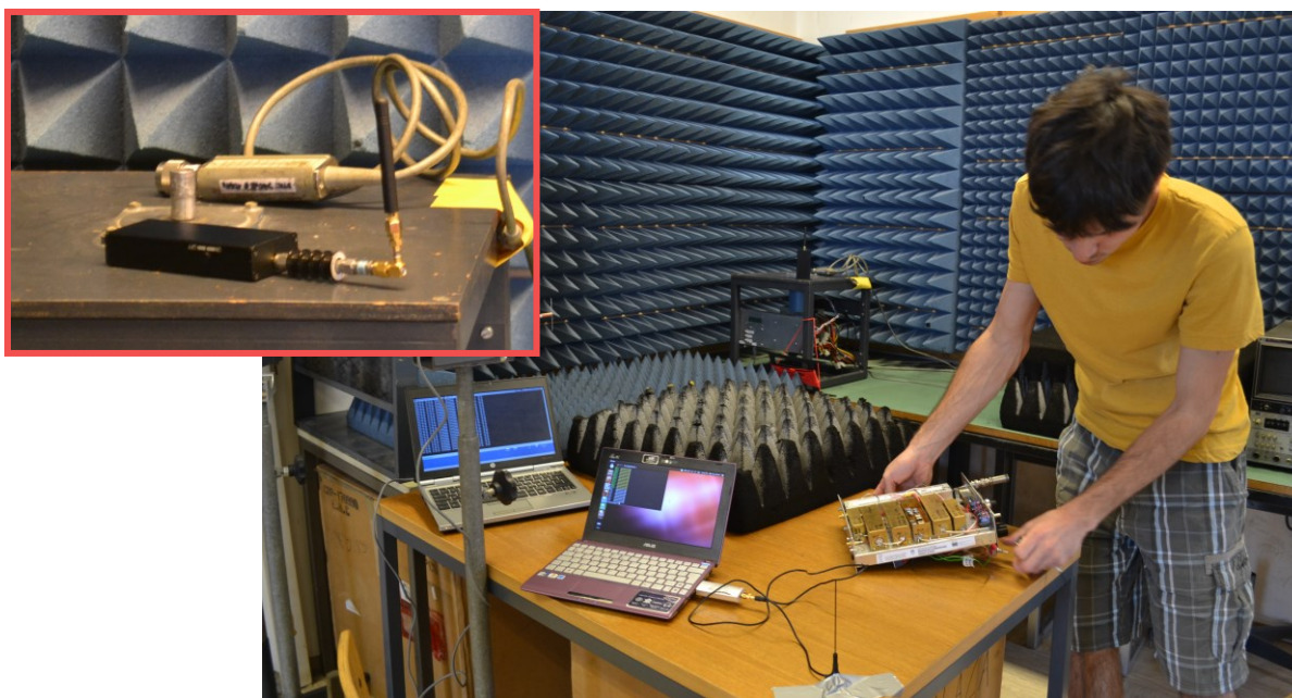
Slika 14: Priprava na primerjalno meritev v Laboratoriju za sevanje in optiko, UL FE. Levo motilnik, opremljen s slabici.
