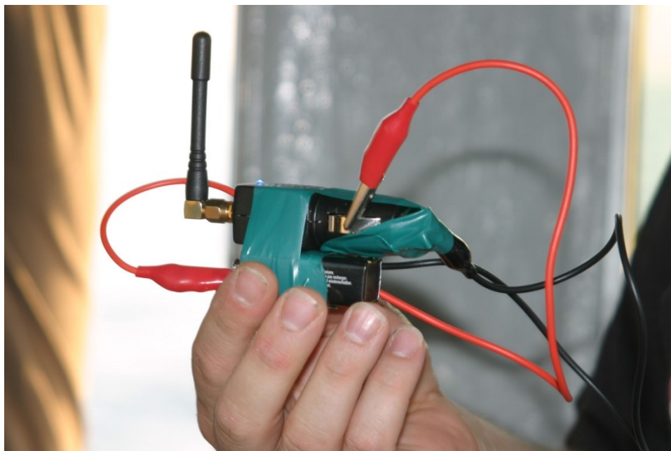
Slika A.4: Eden izmed treh uporabljenih motilnikov GNSS
