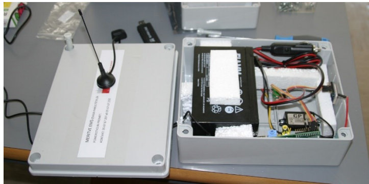
Slika A.5. Detektor EMSDR sestavlja RTL-SDR na platformi Raspberry-Pi, za zagotovitev podatka o točnem času je dodan je še sprejemnik GPS.
