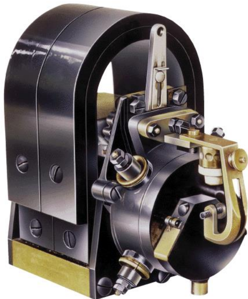
Sustav magnetskog paljenja iz 1902., Bosch
