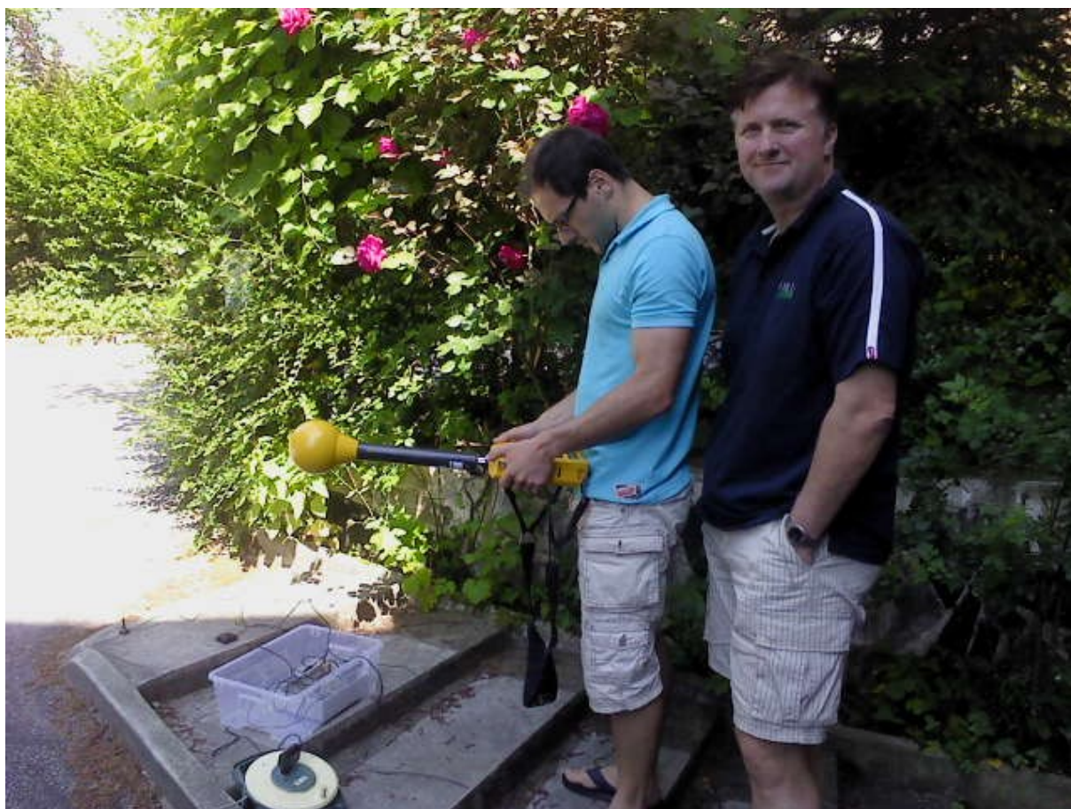
SLIKA 1 SOČASNI ZAJEM Z DETEKTORJEM EMSDR (V PLASTIČNI POSODI) IN OSEBJE INIS, KI IZVAJA MERITEV S PROFESIONALNO MERILNO NAPRAVO NARDA SRM 3006 , SEDEŽ INIS, LJUBLJANA, 5. JUNIJ 2015. (FOTO: F. DIMC)
