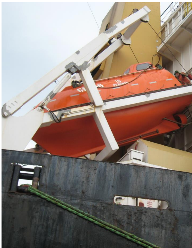
Slika 52: Prostopadni čoln in sistem spuščanja
