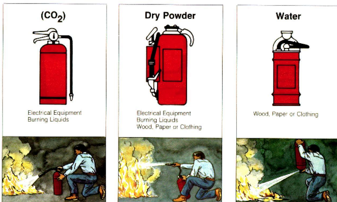
Slika 36: Ročni gasilni aparati
