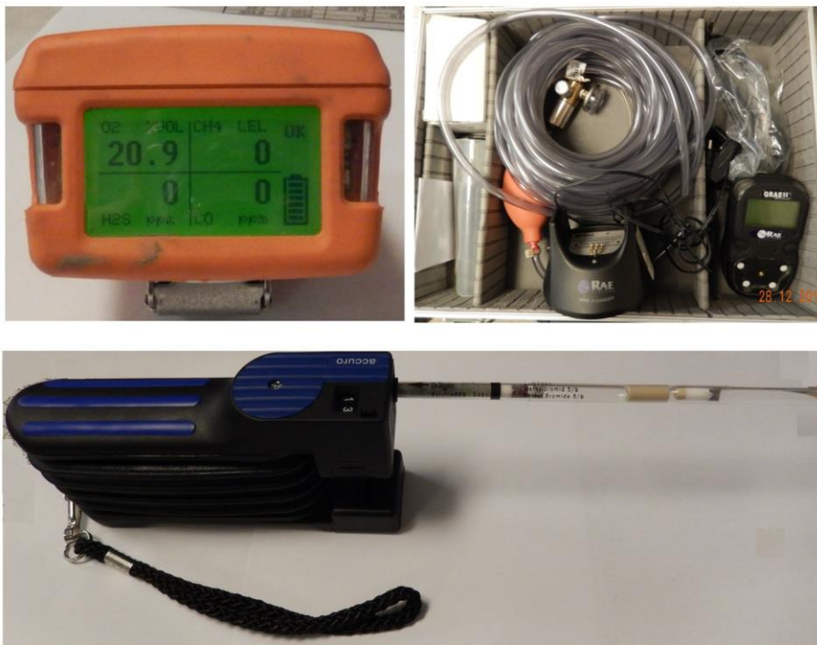
Slika 67: Testerji za analizo atmosfere v prostorih (digiralni in ročna črpalka z merilno eproveto)
