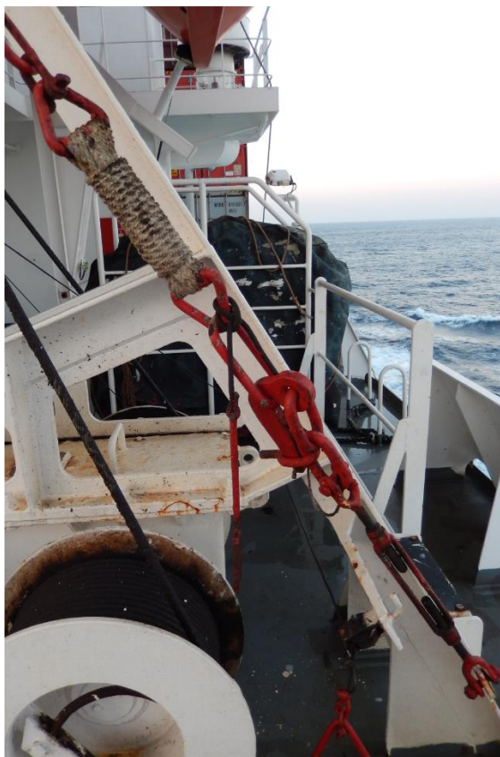
Slika 51: Pripetje čolna v pospravljeni poziciji Prostopadni sistem spuščanja
