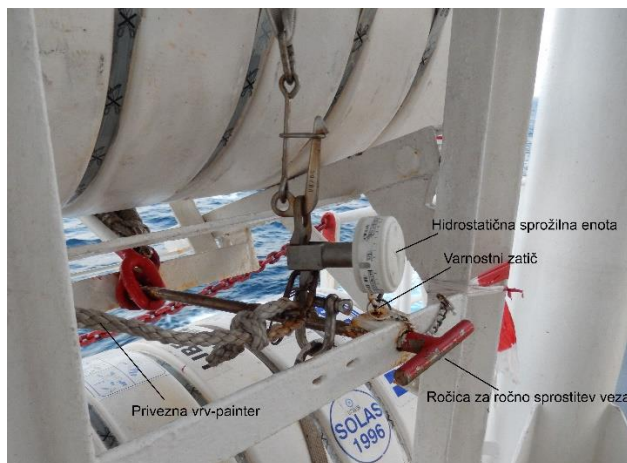
Slika 50: Morski vez rešilnega splava
