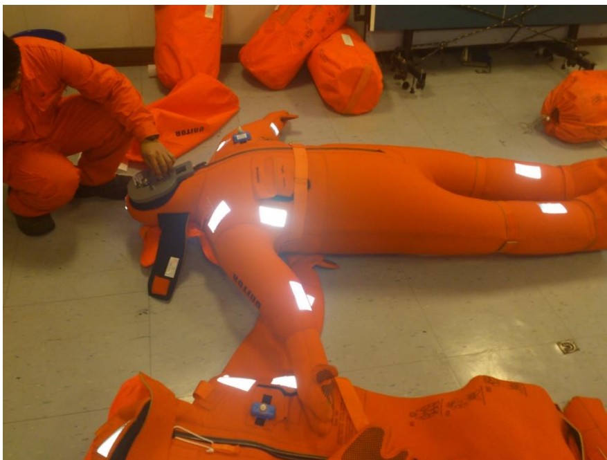
Slika 54: Testiranje hidrotermična obleke na ladji (2 kPa)
